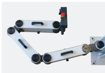
In opzione è possibile avere l'asse X prolungato per raggiungere una distanza di 1850mm. Peso massimo ammissibile per questa versione: 100kg.
