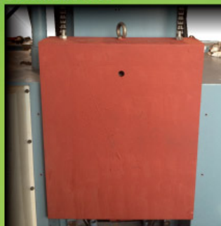
Z軸配重設計 Z axis Counter weight balance (500kgs)
