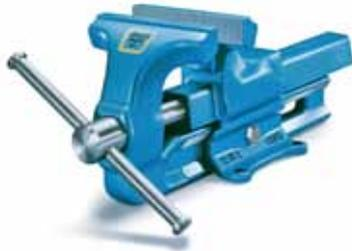
精密的鍛造軌道提供更強大的夾持深度，內部的雙菱柱型軌道設計可有效提供最佳的保護。經精密加工的軌道表面保證穩定、平順的運動。另外值得一提的特點是受雙動不規則四邊形螺紋及便於調整的中央導桿所完善保護的軸心，確保最高的精確度。精密的軸承完善的被安裝在鍛造夾爪的前方，可避免任何可能的損壞。鍛造軌道準確的維持導桿的運作順暢，完全不會產生搖晃或不穩定的現象。
