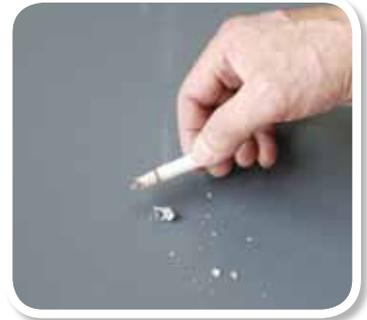
經煙灼試驗，表面無灼痕、龜裂及起泡，表面可耐高溫達180°C。
