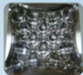
車燈殼反射模具 成品表面如鏡面一般
