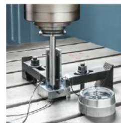
主軸熱變位補償功能 Thermal growth compensation device for spindle
