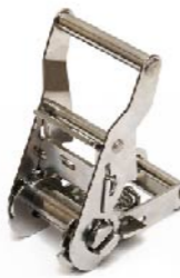
1.5" Light Duty Stainless Ratchet Bukcle RBS38-001 Size: 1.5"/35mm B.S: 1200kg SUS 304 / SUS 316 Middle handle type Aluminum grip
