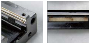
上儲油塊完好 供油正常 軌道面正常
