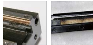
潤滑油乾涸殘留物 上儲油塊破損
