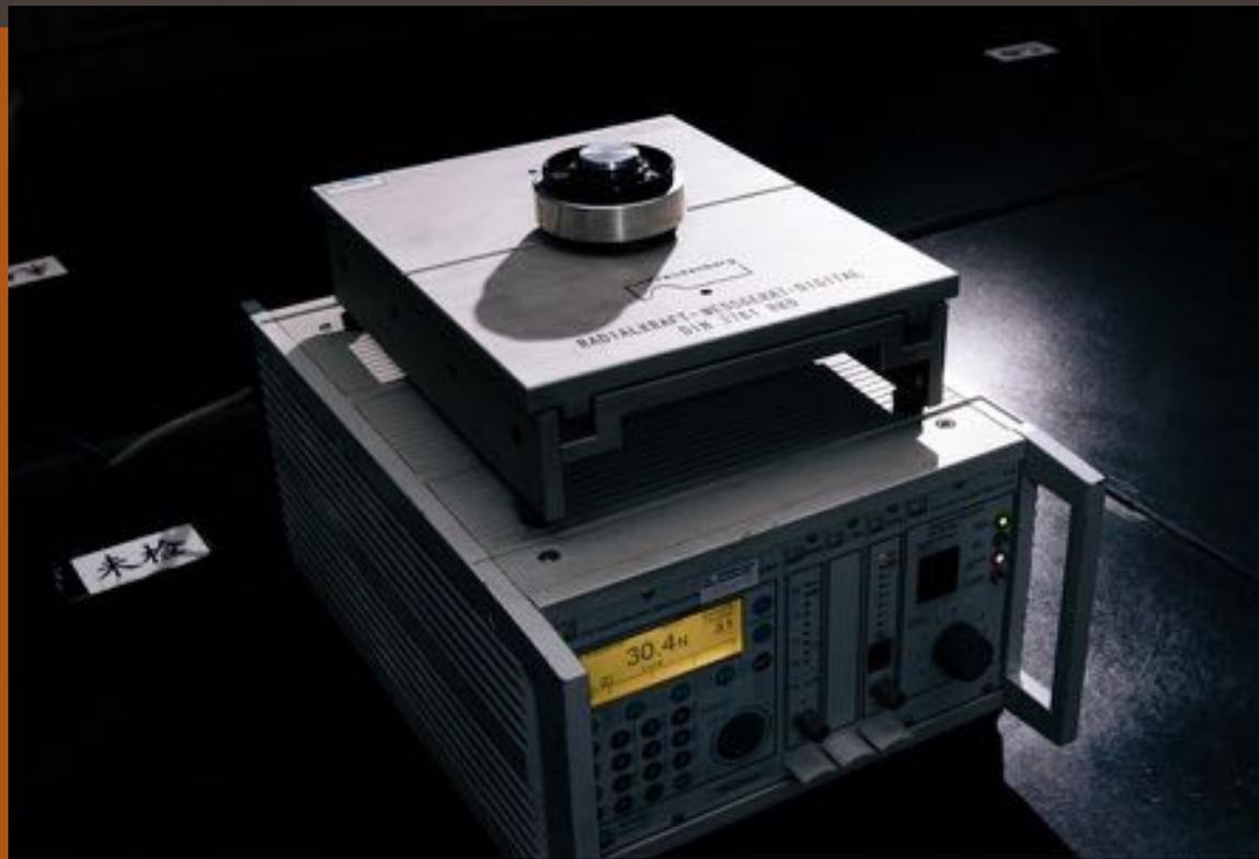
油封緊迫力測試機
