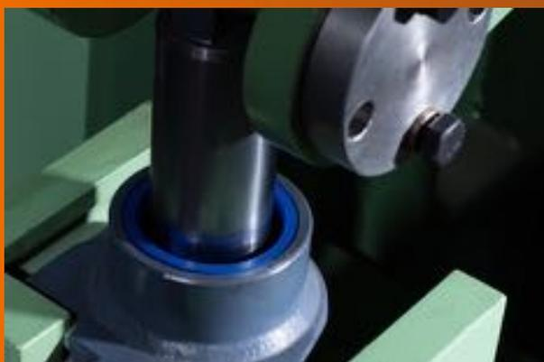
油封壓力測試機
