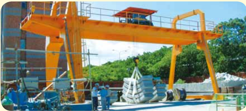
台北內湖捷運工程 - 雙軌鋼索式吊車 & 工程承包 Taipei Metro - Neihu Line - Double-rail wire rope hoist
