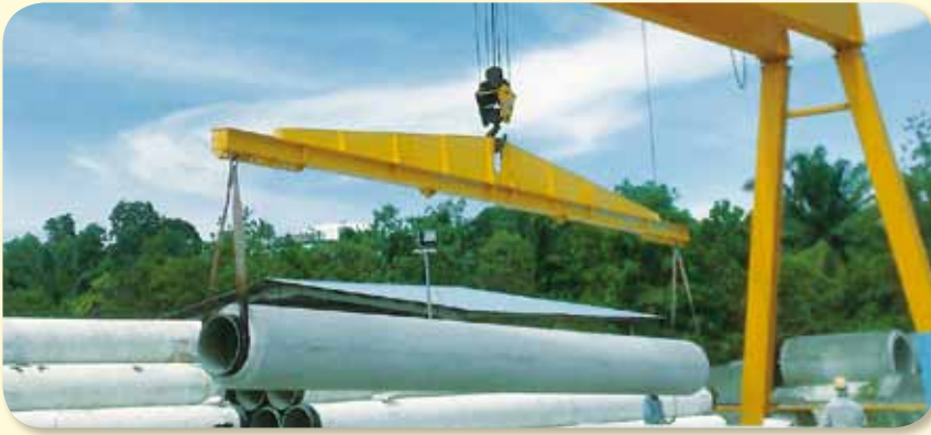
馬來西亞高速公路工程使用 Outdoor Gantry Crane in Government Construction (Malaysia)
