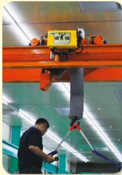
半門型煉鋼廠使用 Half Gantry Crane
