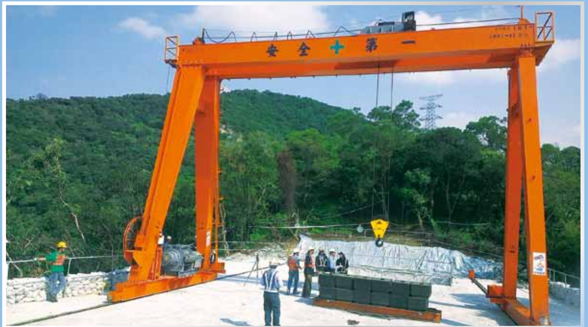
台電工程 特殊高揚程 120M 雙軌鋼索吊車 Taiwan Power Company Project / Double-Rail Wire Rope Hoist with Special High Lift - 120M.
