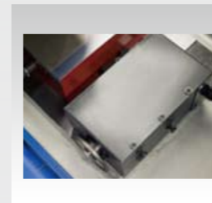
■ 鑽石滾輪裝置
