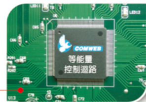
• 智慧型等能量加工迴路，使加工效率可達180mm 2 /min，表面粗糙度Ra≥0.8um。
