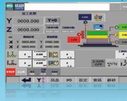
工件研磨條件尺寸設定與上下進給資訊 (可分粗磨、細磨、零研磨設定)
