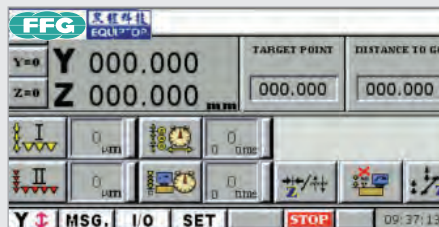
上下進給(可分粗磨、細磨、零研磨設定) 顯示最小單位: Y軸0.001mm / Z軸0.001mm
