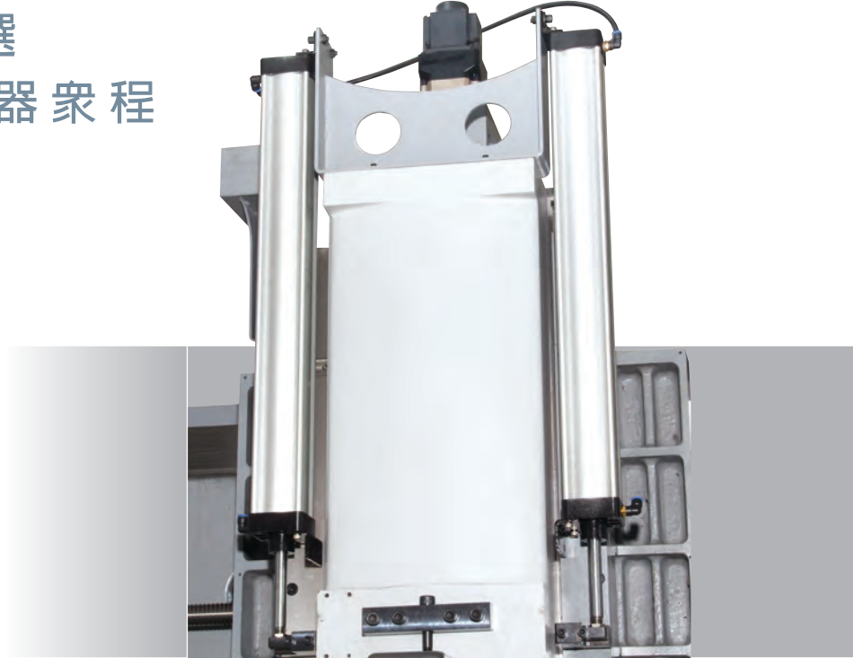
▲汽缸配重搭配伺服煞車馬達裝置 (15300~15500)
