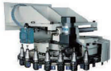
16/20 支刀庫的選擇裝置，提供客戶自動換刀及多刀選擇。 Option 16/20 pcs ATC tool changer.
