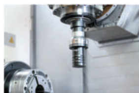
Draw-in force 主軸拉力量測
