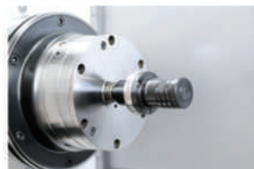
I.D. clamping 內徑夾持力量測
