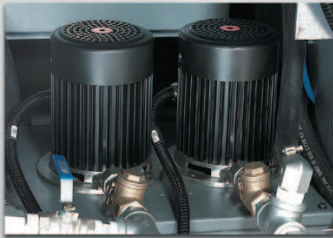
直立式泵浦： 泵浦加上逆閥可防止在缺水後 又補水無法抽取之困擾。
