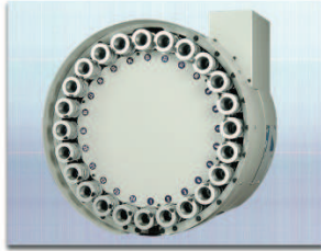
高容量刀庫 (40刀) 刀庫採鏈條式刀倉設計容量大，可儲存32支 刀具，能適應各種加工需要，且刀具的管理 與登記非常方便。符
