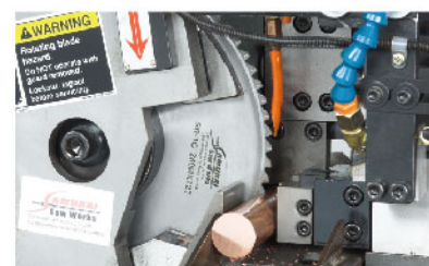
SR-7C 切銅用鋸片 適合切銅棒的鋸片。
