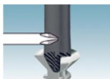
PHOENIX CONTACT 的十字螺絲起子前端有止滑紋路，採用螺絲的十字孔不會滑牙的構造
