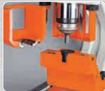
*鵝頸式下鋸座，便於槽鐵的緣部與底部沖孔
