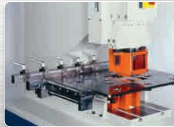
*多點式定工作台(限用於S/SD/KD及PM機型)
