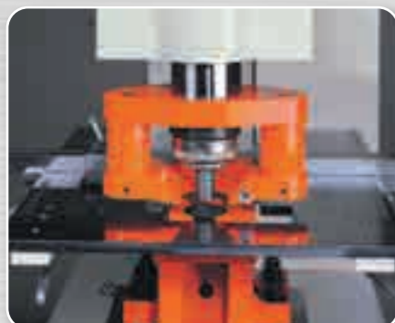
*優力膠式的剝料器，可降低沖孔時的變形
