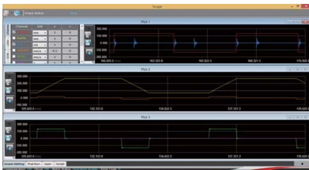
監控器能以時序圖即時監看驅動器資訊無須另行準備示波器等檢測儀器。
