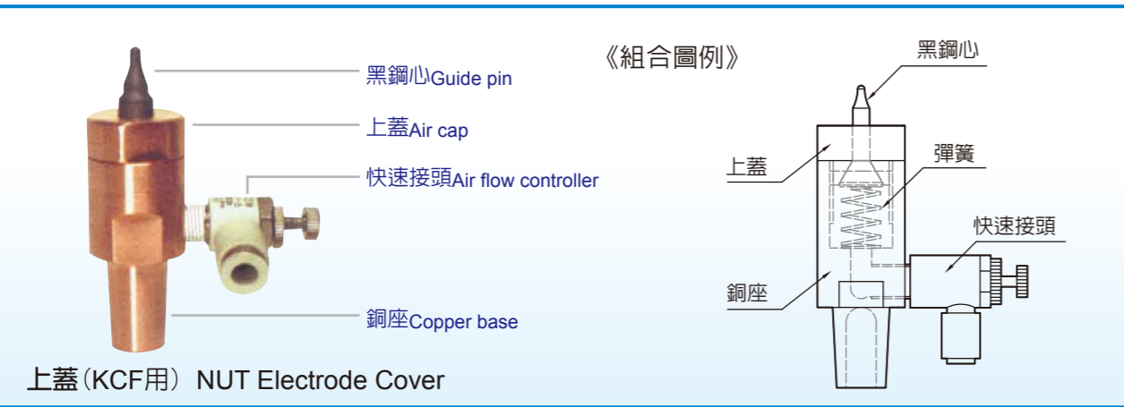
電極座上蓋 Air Cap for Nut Welding
