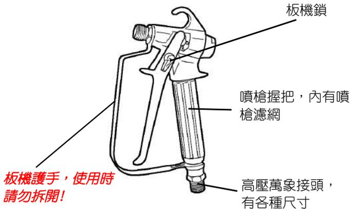
**警告：**噴頭如果沒有確實接好有可能會造成噴射傷害。請隨時注意在拆卸，安裝，清潔噴嘴時將板機鎖扣上。並請絕不要用手指清理噴嘴。
