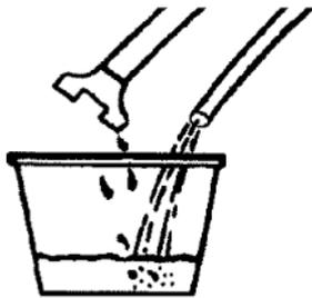
4. 將吸料管及洩料管放置在桶內，以適當的溶劑沖洗管道及幫浦內部，直到清潔為止，並且順便清洗金屬吸料管外部！
